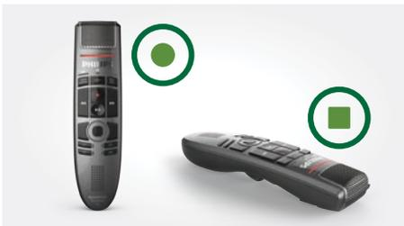
Das Philips SpeechMike Premium Air verfügt über einen integrierten Bewegungssensor. Der Bewegungssensor erkennt, wenn das Gerät auf den Tisch gelegt wird, und schaltet das Mikrofon stumm. Sobald Sie es wieder zur Hand nehmen, wird das Mikrofon wieder aktiviert. Zusätzlich können benutzerdefinierte Einstellungen vorgenommen werden, damit das Gerät die Aufnahme automatisch unterbricht und wieder fortsetzt.
