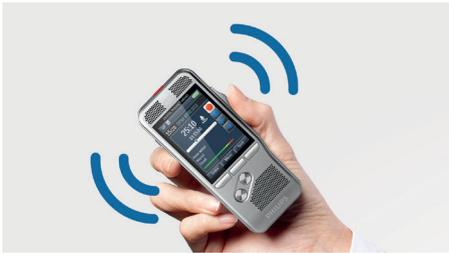
Der integrierte Bewegungssensor erkennt, ob das Gerät auf einem Tisch platziert oder in der Hand gehalten wird und wählt entsprechend das passende Mikrofon für die Aufnahmesituation. Der Bewegungssensor schaltet automatisch auf Standby, wenn das Gerät inaktiv ist. Nehmen Sie das PocketMemo wieder in die Hand, ist es in weniger als einer Sekunde aufnahmebereit.
