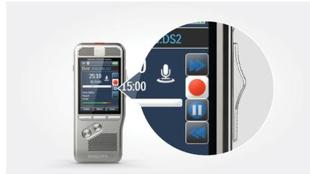
Schiebeschalter-Bedienung (schneller Vorlauf, Aufnahme/Wiedergabe, Stopp, schneller Rücklauf)
